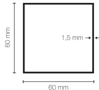
Le poteau carré est fabriqué en acier galvanisé Z-275 de 1,5 mm d'épaisseur. Sa conception optimale assure la rigidité de son installation.
