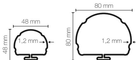
Grâce à son système de crémaillère, ce poteau de diamètres 48 et 80 mm permet de placer les accessoires sur toute la longueur selon les besoins de l'installation. Ce même poteau crémaillère peut être utilisé indistinctement pour des panneaux à plis ou en simple torsion.
