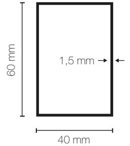
Le poteau 60 x 40 mm de section rectangulaire est fabriqué en acier galvanisé Z-275 de 1,5 mm d'épaisseur.
