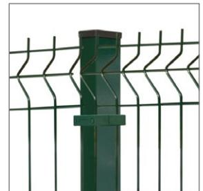
Les vis sont invisibles et sont protégées par des bouchons en plastique. Les membranes de fixation intérieures du collier s'emboîtent sur la baguette du panneau permettant une fixation ferme et empêchant que celui-ci ne tombe ou ne bouge.
