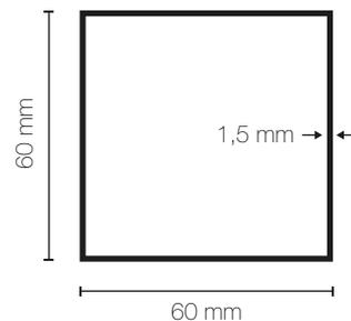
El poste cuadrado está fabricado con acero galvanizado Z-275 de 1,5 mm. de espesor. Al tener un mayor desarrollo ofrece una mayor rigidez a la instalación.
