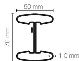
La consistencia y aspecto de este poste lo hacen idóneo para grandes cerramientos, su rigidez permite la instalación de láminas de ocultación. Sus accesorios de fijación permiten una instalación a medida, ya que pueden ubicarse en cualquier posición del poste en función del terreno.
